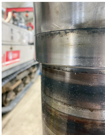
Bague d'étanchéité (après les tests)
