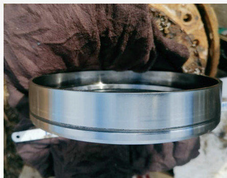
Bague d'étanchéité - Revêtement TEKAD 1000 - Procédé DED
