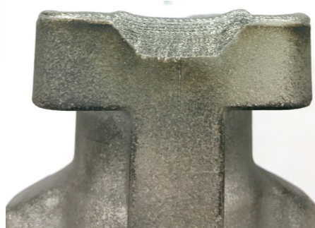
Couvercle de serrage réparé
