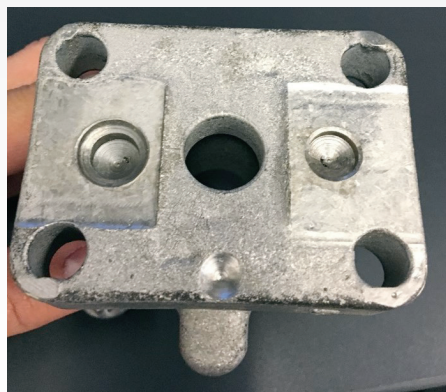
Couvercle de serrage avec défaut.
