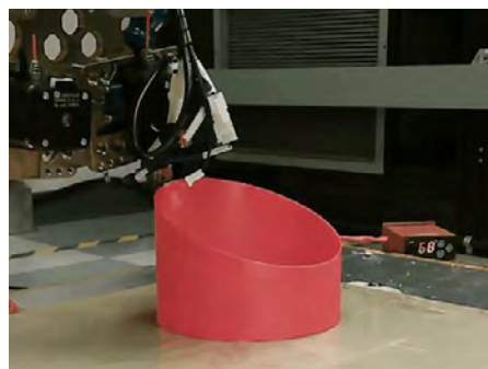
Figure 3 – Impression 3D d'un cylindre tronqué avec un rapport avant/arrière de 2:1 et un nombre constant de couches de PLA au moyen de la méthode par FDM.
