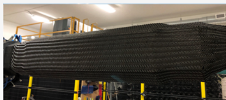
Figure 1 – Mandrin ABS imprimé 3D recouvert d'une tresse en fibres de carbone.
